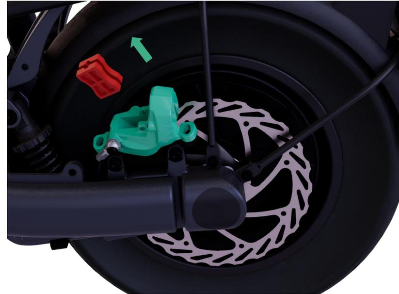
1. Entnehme nun die beiden Distanzblöcke wieder aus dem Bremssattel (siehe Bild 1 und Bild 2).
