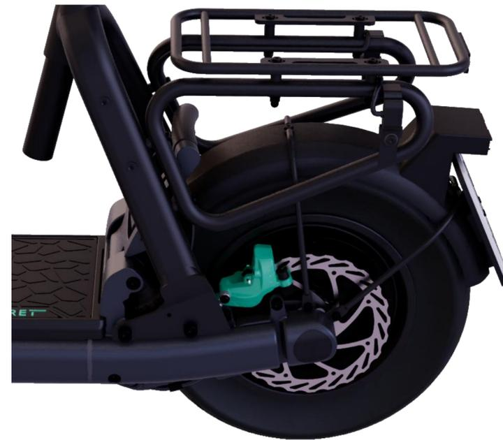
1. Schraube anschließend das Gepäckträgergestell wieder mit den insgesamt vier Innensechskantschrauben (ISK 6), jeweils zwei pro Seite, mit einem Drehmoment von circa 25–30 Nm fest (siehe Bild 1 und Bild 2).
