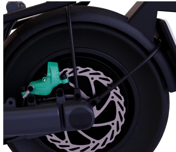
1. Schraube nun die beiden Innensechskantschrauben (ISK 4), mit denen der Bremssattel am Bremssattelhalter befestigt ist, mit einem Drehmoment von etwa 10–12 Nm fest. Der Bremssattel sollte danach wieder bewegungsfrei und sicher sitzen (siehe Bild 1 und Bild 2).
